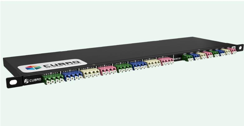
Cubro OPTOSLIM TAP系列可提供对物理光学数据链路的实时监控访问，无性能分级或中断。由于光纤TAP是完全无源的（不需要电源），因此将它们串联在有源链路上没有任何风险。TAP会在有源链路上引入额外的光功率损耗，该损耗随分光比而变化；否则，TAP对网络是完全透明的。
