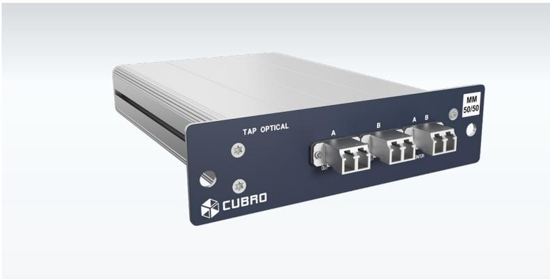
Cubro OPTOSLIM TAP系列可提供对物理光学数据链路的实时监控访问，无性能降级或中断。由于光纤TAP是完全无源的（不需要电源），因此将它们串联在有源链路上没有任何风险。TAP会在有源链路上引入额外的光功率损耗，该损耗随分光比而变化；否则，TAP对网络是完全透明的。
