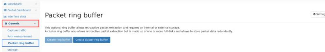
必须指定环形缓冲区的大小。如果存储设备上不需要 pcap，则环形缓冲区将使用 100% 的存储设备容量。
