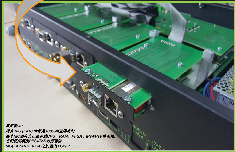
4个NIC(EXPANDER 1-4)是自主时间服务器。与主板的模拟通信PPS+ToD(无TCP/IP)。
